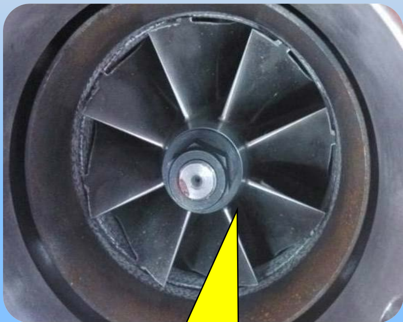
喘振造成擦壳，压气机叶轮磨损图片。 (该增压器转子轴向和径向间隙正常)
