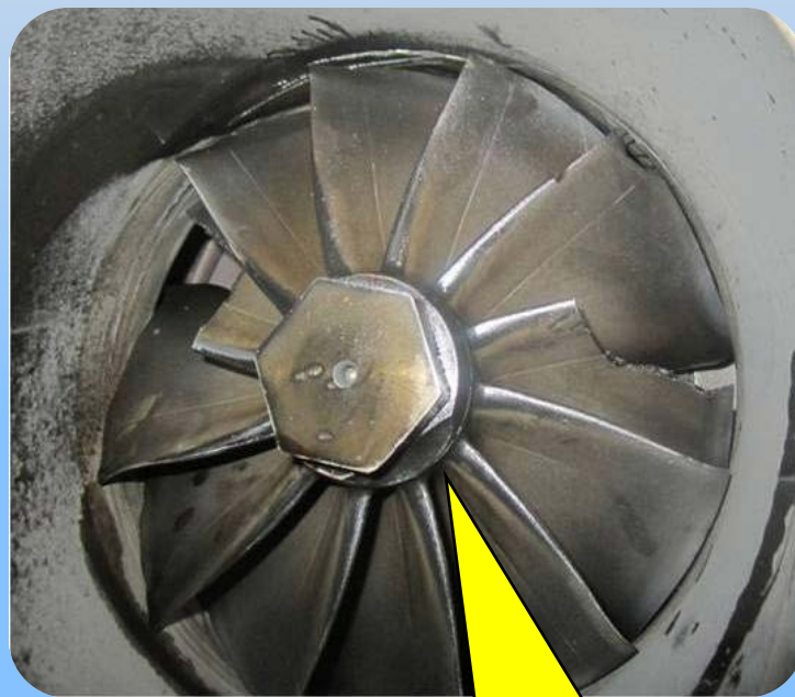
喘振损坏的 涡轮叶片。
